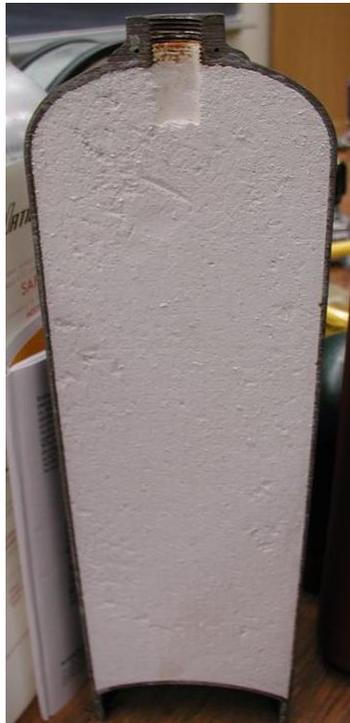
**L'acetilene viene immagazzinato in bombole all'interno di una massa solida porosa dove è disciolto grazie all'introduzione di un solvente (acetone o dimetilformammide) con pressioni di carica che superano le 10 atm.**
